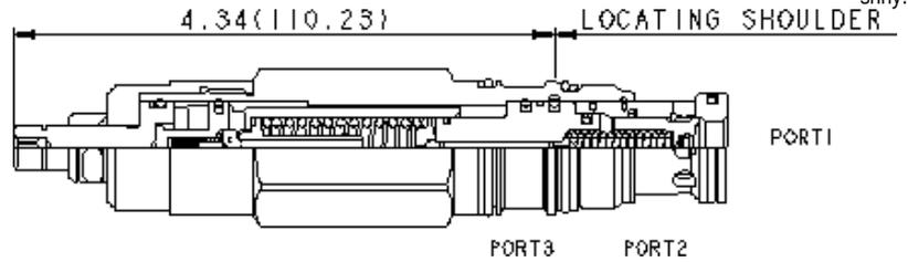
Vorgesteuerte, weiche Druckbegrenzungsventile begrenzen den maximalen Systemdruck und die Geschwindigkeit des Druckanstiegs. Die Ventile öffnen zuerst und schließen dann gleichmäßig rampenförmig vom unteren Druckeinstellwert (Schwellwert) bis zum eingestellten Maximalwert. Die Rampenzeit ist dabei unabhängig von der Ventileinstellung und dem Volumenstrom. Über die Verstellerschraube können der Maximalwert und der Schwellwert eingestellt werden.
